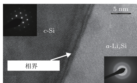
(b) 部分锂化后的高倍透射电镜照片, 相界宽度大约为 1 nm (Chon et al. 2011)
