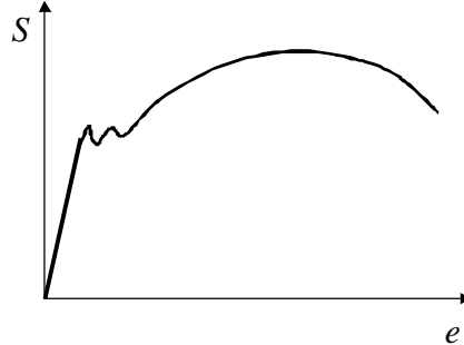
Figura 1: Curva tensioni deformazioni ingegneristiche
